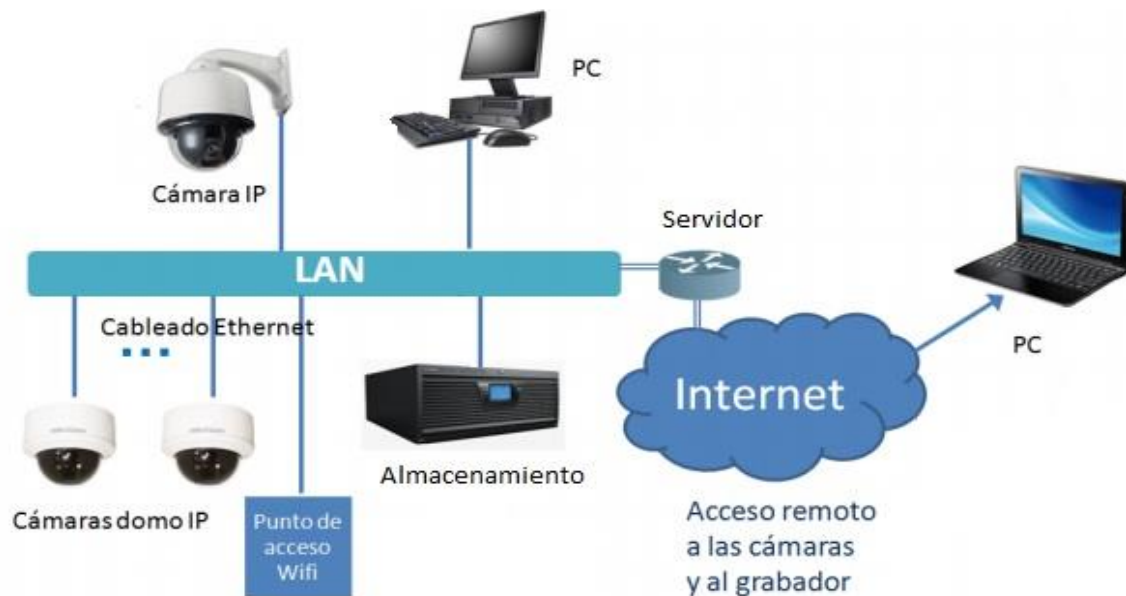
Figura 5. Esquema básico sistema CCTV
