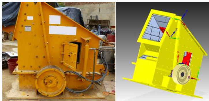
Figura 34 fotografía y diseño carcasa o cuerpo completo molino de tres escudos tres líneas para martillos
