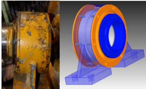
Figura 22. Fotografía y diseño Chumacera dos tapas con hueco.
