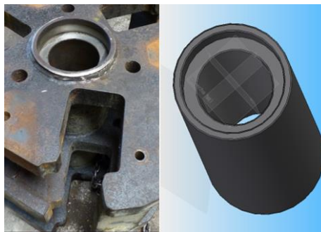
figura 17. Fotografía y diseño Tubo protector con buje fijación sit-lock molino para tres escudos.
