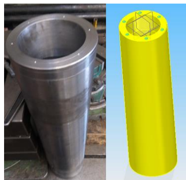
figura 18: Fotografía y diseño Tubo protector con buje de desmontaje molino para cuatro escudos.
