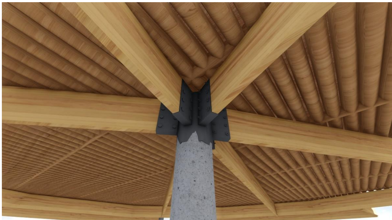
Figura 10. Detalle constructivo de cabañas
