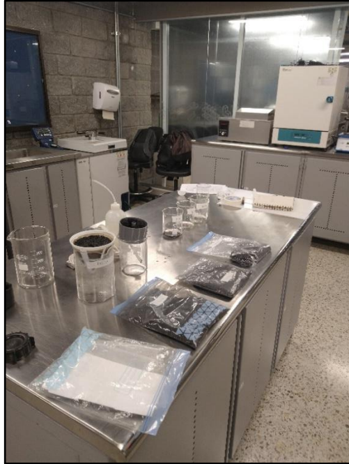
Ilustración 26. Estabilización del pH para los carbones activados. Fuente [Propia]
