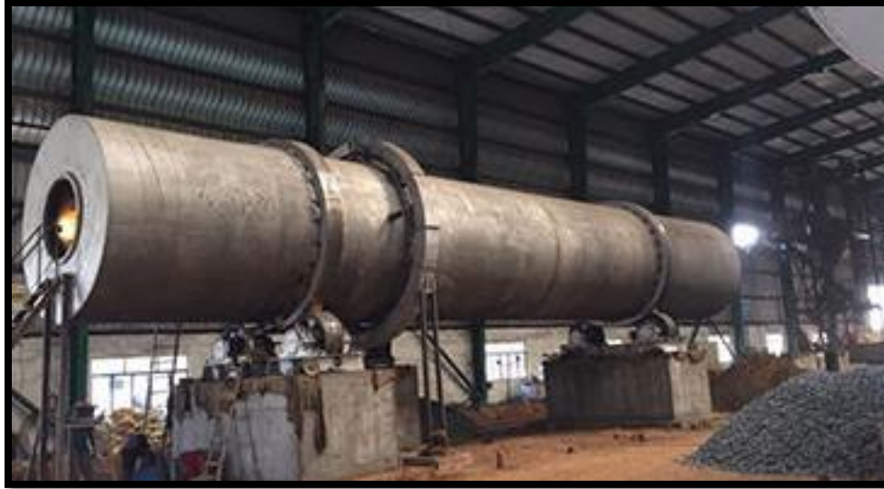
Ilustración 21. Horno Rotatorio para activación de carbón activado [47]
