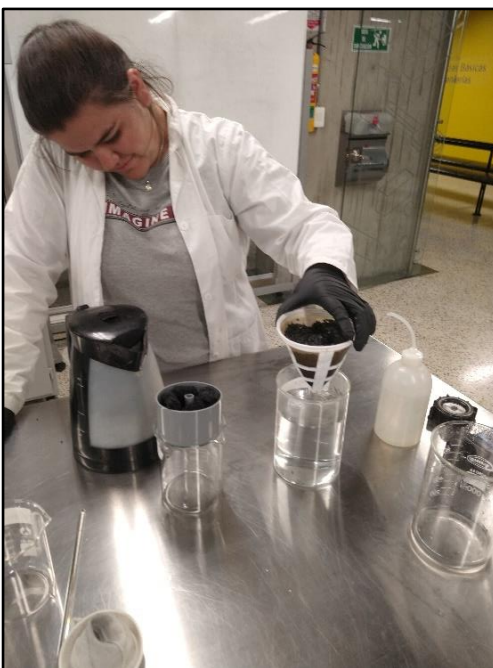
Ilustración 24. Lavado de carbones activados. Fuente [Propia]
