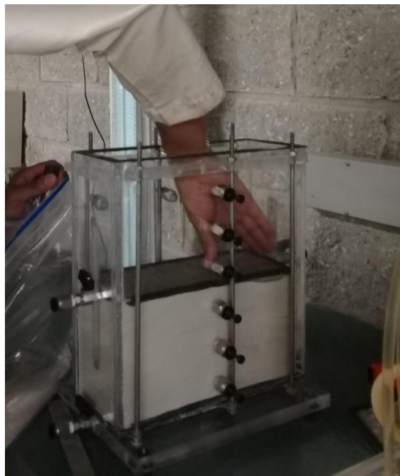
Figura 5. Colocación de la malla 200 entre las arenas
