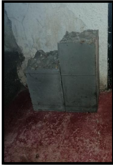
Figura 17. Rotura de vigas concreto normal.
