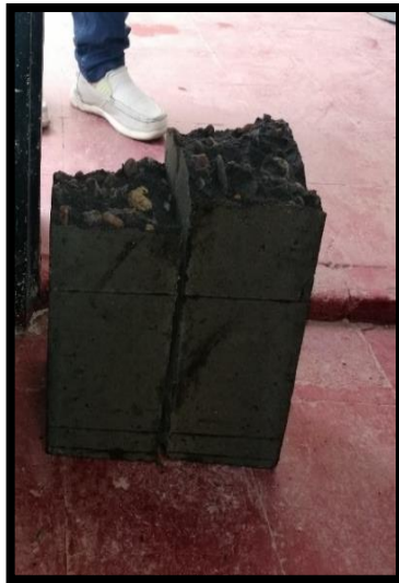
Figura 18. Rotura de vigas concreto con ceniza de cascarilla de arroz.
