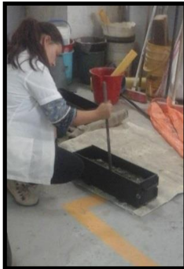
Figura 14. Llenado de molde de la viga.
