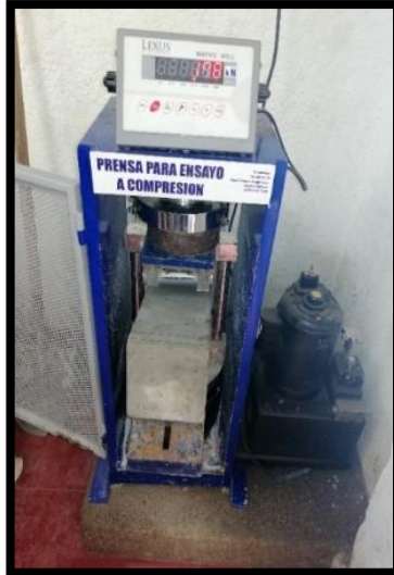
Figura 15. Viga Concreto Normal.
