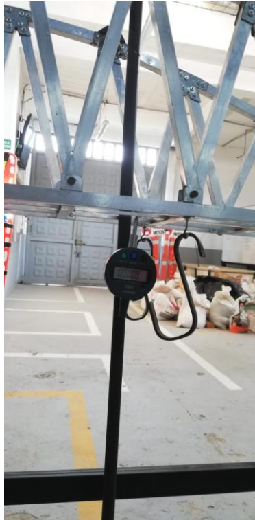
Ilustración 17 Forma de uso de los deformímetros Fuente: los Autores
