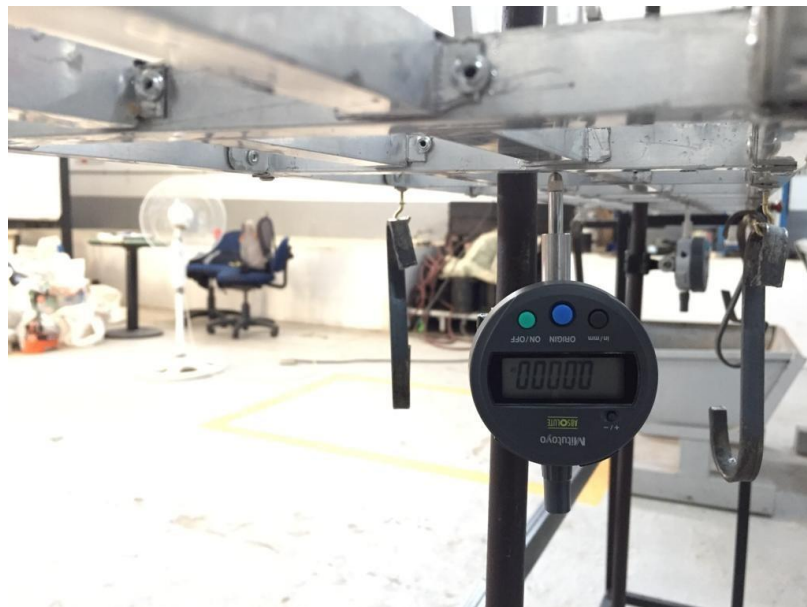
Ilustración 21 Colocación Deformímetro Fuente: los Autores
