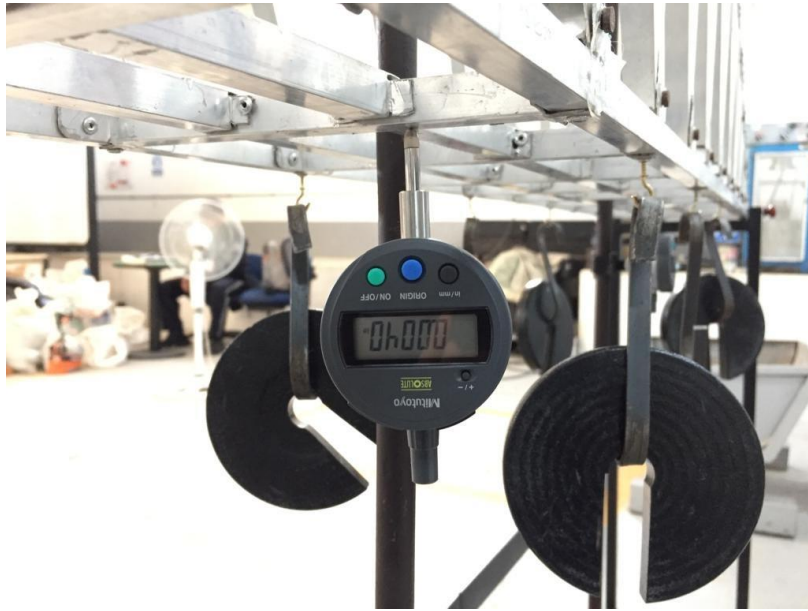
Ilustración 18 Estructura con los pesos y el deformímetro Fuente: los Autores
