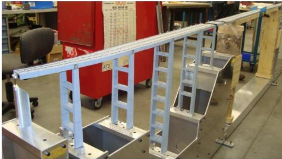
Ilustración 1 Modelo aeroelástico del puente (no se muestran pilones) (Pozos, Raúl, & Roberto, 2012)
