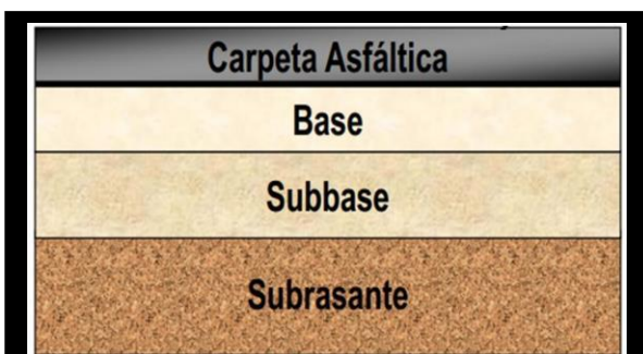
Imagen 1. Estructura típica del pavimento flexible.
