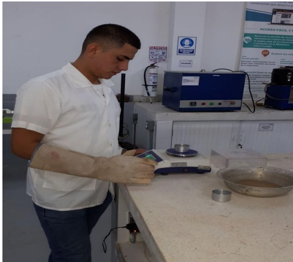
Figura 20. Toma de pesos secos del material.
