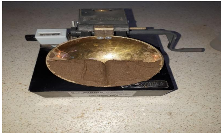
Figura 18. Extracción del material en donde se presentó el cierre con los golpes de la máquina de casa grande.
