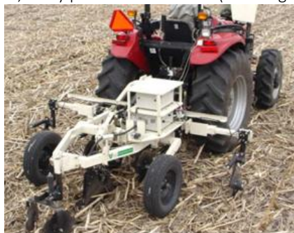
Figura 1. Sistema de detección de EC, OM y pH sobre-la-marcha (on-the-go)
