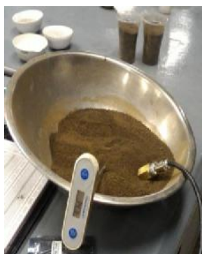
Figura 9 . Medición de temperatura con sensor SHT10
