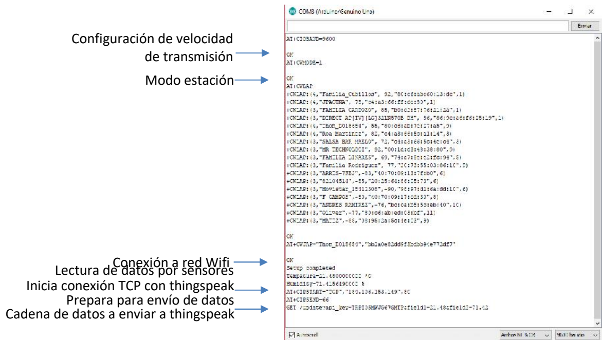
Figura 32. Configuración del módulo esp8266 y thingspeak
