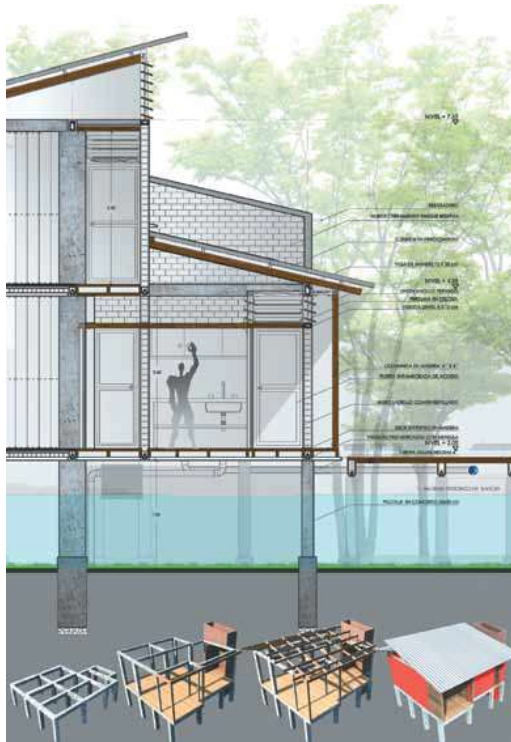
Figura 29. Sistema constructivo de la vivienda.
