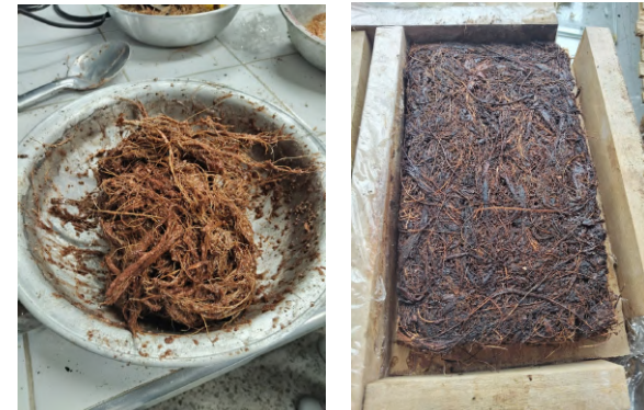
Figura 13 - 14: Elaboración de probetas desde materia prima, elaboración de aglutinante, mezcla y moldeado: Elaboración propia 2026
