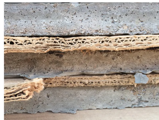
Figura 3: Compuesto de cemento y fibras de coco, referente de uso de fibras naturales en elementos constructivos. Tomado el 06/04/2026 de Evaluation of mechanical and thermal performance of jute and coconut fiber-reinforced epoxy composites with rice husk ash for wall insulation applications , por M. A. Akhter y D. Mondal, 2025, Journal of Biobased Materials and Bioenergy , 19(1), pp. 118–127 2025.
