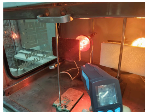
Figura 4: Prueba de conductividad térmica, comparativa entre lana de coco (izquierda) y EPS (derecha), mediciones tomadas gracias a un termómetro láser, elaboración propia 2025
