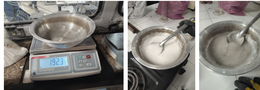
Figura 10 - 12: Elaboración de probetas desde materia prima, elaboración de aglutinante, mezcla y moldeado: Elaboración propia 2026
