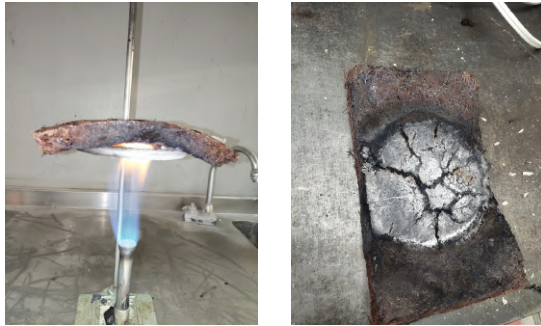
Figura 16, 17: Ensayo ignífugo realizado en una probeta de lana de coco en la Universidad Piloto de Colombia. Elaboración propia 2025
