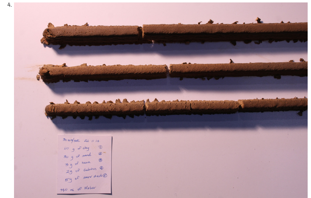
Figura 4. Ensayos iniciales de impresión con arcilla FP CH 0-0,2 mm, mostrando signos de contracción en múltiples puntos de una impresión lineal recta con una contracción superior al 2 %.
