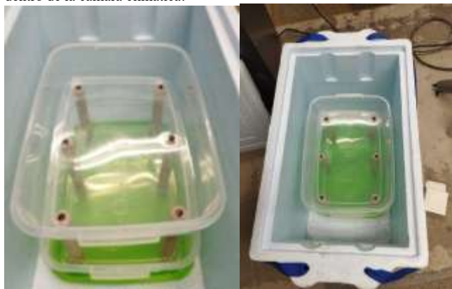
Figuras 2 y 3. Montaje de contenedores de plástico para ubicar las muestras dentro de la cámara climática.
