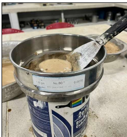
Ilustración 28 : Tamizado de la mezcla entre aserrín y NaOH al 5% Fuente: Tomado del autor investigativo
