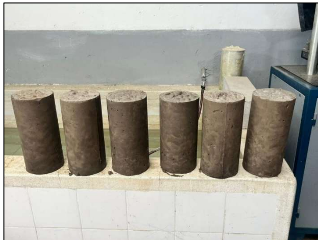
Ilustración 36: Cilindros de concreto desmoldados después de fraguar
