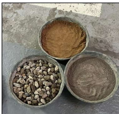
Ilustración 29: Cemento, arena y grava Fuente: Tomado del autor investigativo
