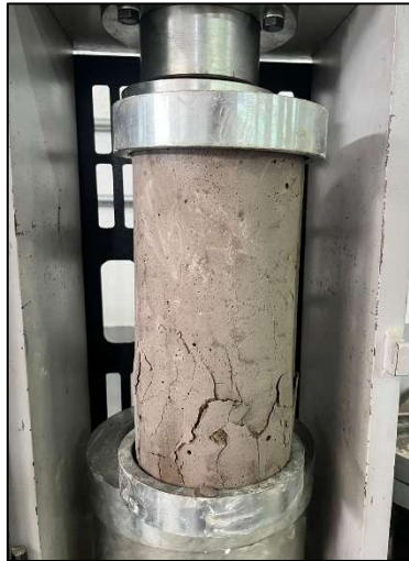
Ilustración 39: Cilindro de concreto fallado en máquina de resistencia a la compresión Fuente: Tomado del autor investigativo
