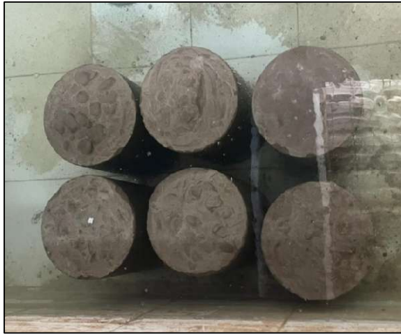
Ilustración 35: Cilindros de concreto sumergidos en agua
