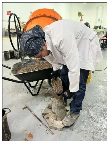
Ilustración 33: Ensayo de asentamiento
