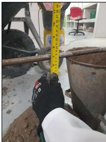
Ilustración 32: Asentamiento de 17cm de mezcla control
