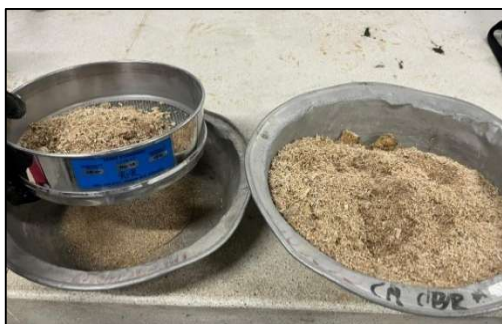
Ilustración 25: Aserrín tamizado por tamiz No.10 Fuente: Tomado del autor investigativo
