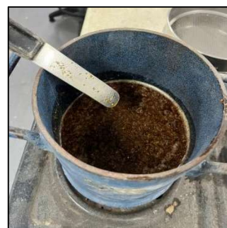
Ilustración 26: Mezcla entre el NaOH al 5% con el aserrín tamizado Fuente: Tomado del autor investigativo
