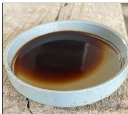
Ilustración 27: Extracto alcalino de lignina Fuente: Tomado del autor investigativo
