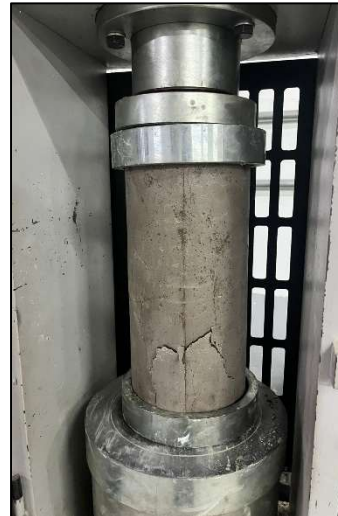
Ilustración 40: Cilindro de concreto fallado en máquina de resistencia a la compresión 2 Fuente: Tomado del autor investigativo
