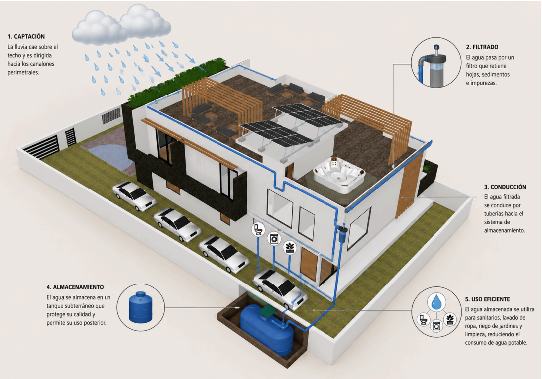
Figura 10 Sistema de recolección de aguas lluvias
