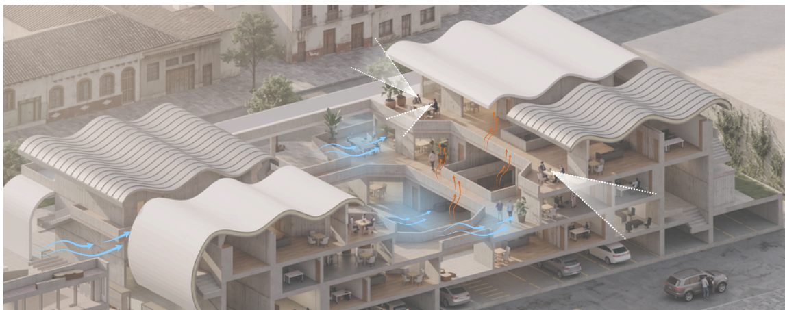
Figura 73 Ventilación natural y aprovechamiento de visuales
