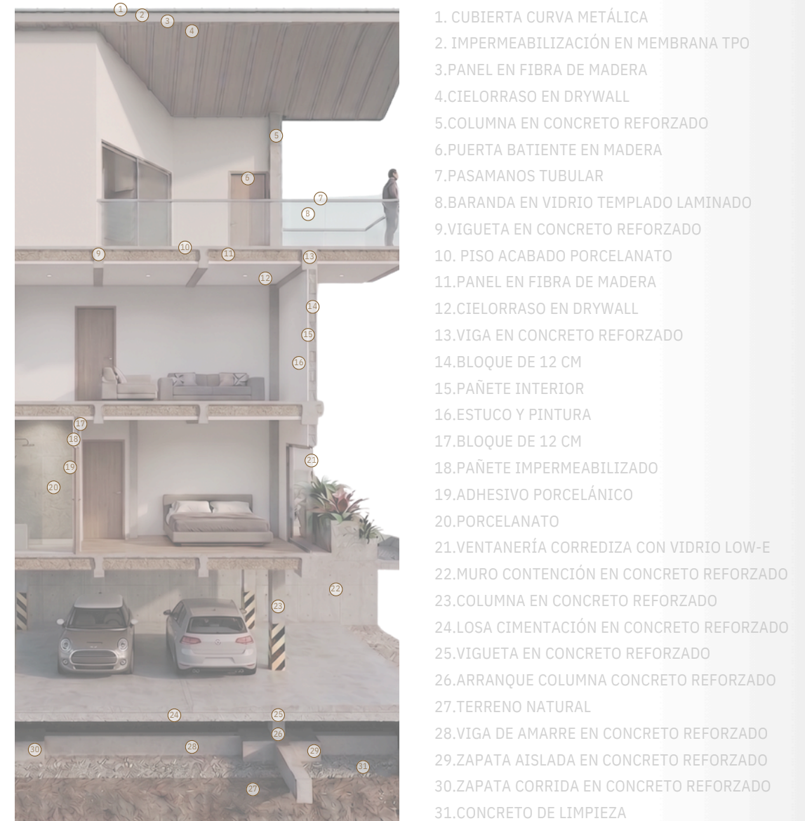
Figura 53 Corte por fachada
