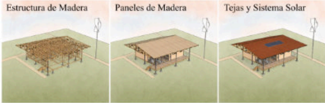
Imagen 14. Detalle axonométrico constructivo evolutivo. Camilo Romero, 2026.
