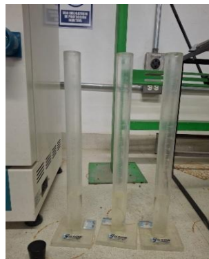
Probetas mostrando la separación entre arena y finos.
