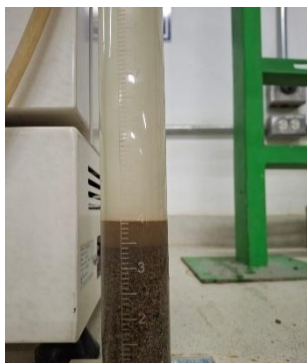
Lectura de la capa de arcilla para la primera muestra.
