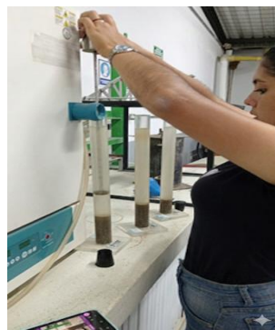
Lectura de la capa de arena para la primera muestra.
