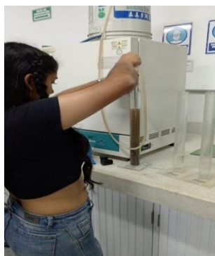
Lectura de la capa de arcilla para la primera muestra.
