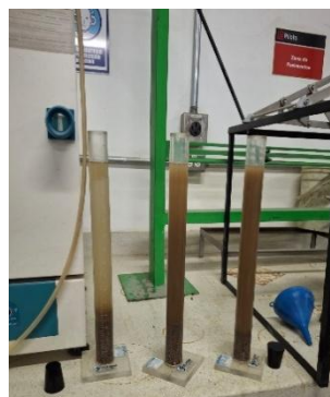
Lectura de la capa de arena para la primera muestra.
