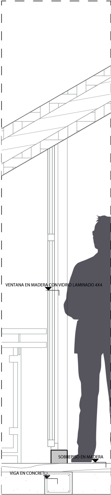
Figura 21. Corte de fachada.
