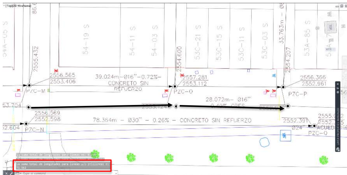
Ilustración 25. Cuantificación de longitud alcantarillado pluvial D 30".
