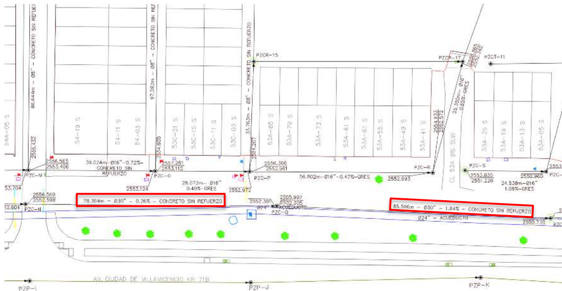
Ilustración 17. Cuantificación de longitud alcantarillado sanitario 30".
