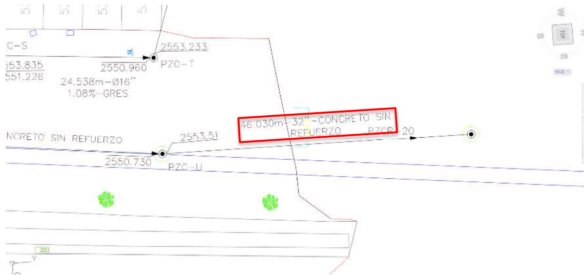
Ilustración 18. Cuantificación de longitud alcantarillado sanitario 32".
