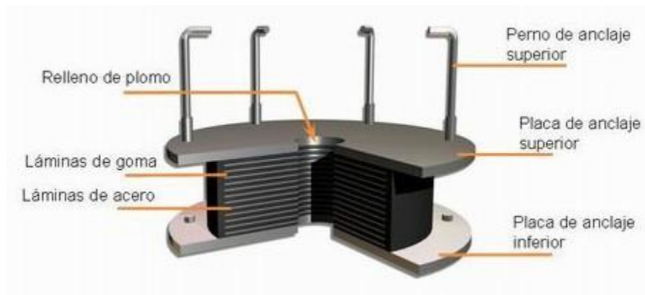
Figura 4. Aislador sísmico de base tipo elastomérico. Nota. Esquema de los componentes del aislador sísmico elastomérico de base. Fuente: Grupo grasa (2020).
