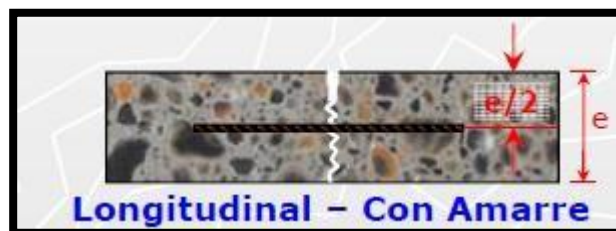
Ilustración numero 28 Ilustración detalle de juntas recomendadas de diseño
