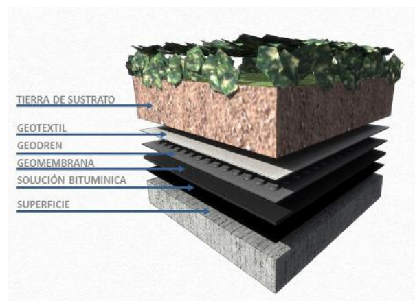
Figura 56. Abatimientos e intersecciones. (2019). Cubierta ajardinada.
