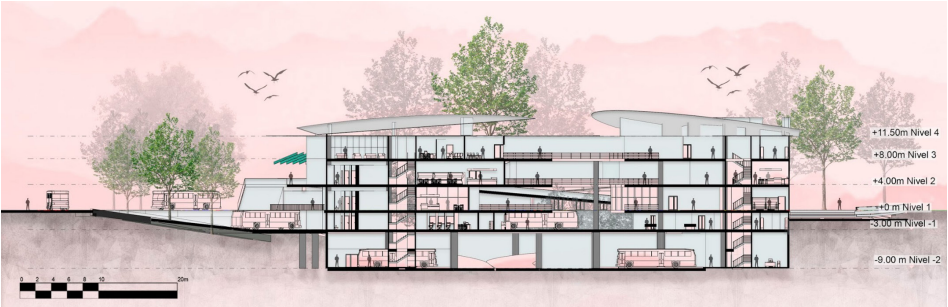
Figura 140. Corte longitudinal terminal de transporte.
