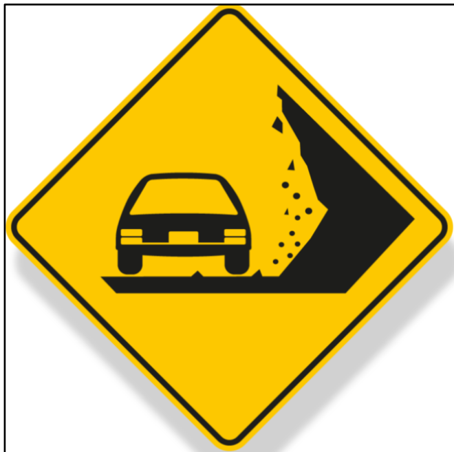
Figura 33 Señal preventiva de zona de derrumbes
