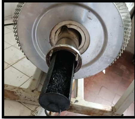
Ilustración 29 Resultado de pirolisis del bagazo de caña. (Fuente propia)
