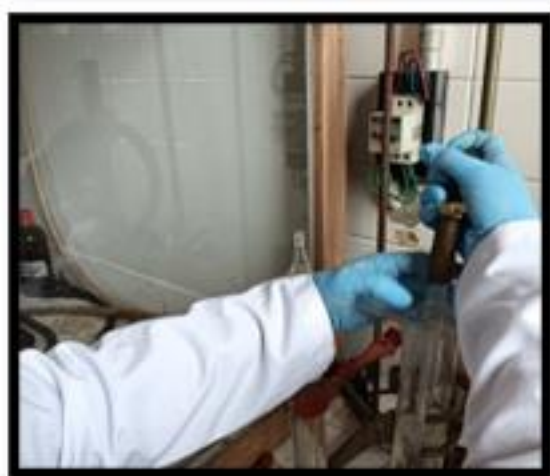
Ilustración 27 Conexión de las mangueras con el reactor. (Fuente propia)
