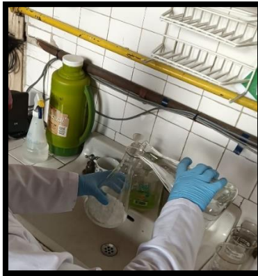
Ilustración 23 inicio de la mezcla de Hidróxido de sodio con agua. (Fuente propia)
