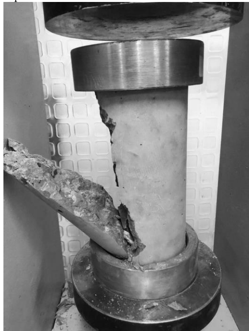
Figura 7 Tipo de falla cilindros de concreto
