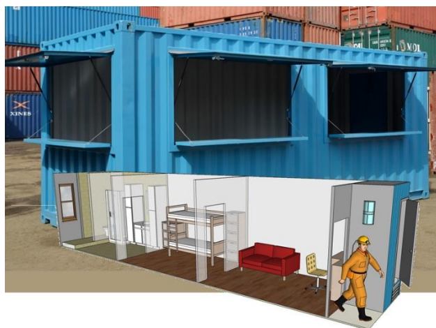
fig. 17. Habitáculos transportables a base de contenedores.
