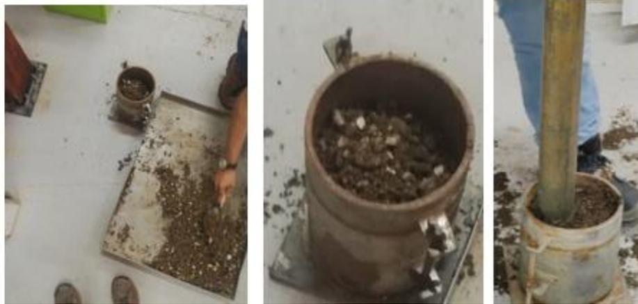
Fuente: Procedimiento del ensayo CBR. Elaboración propia
