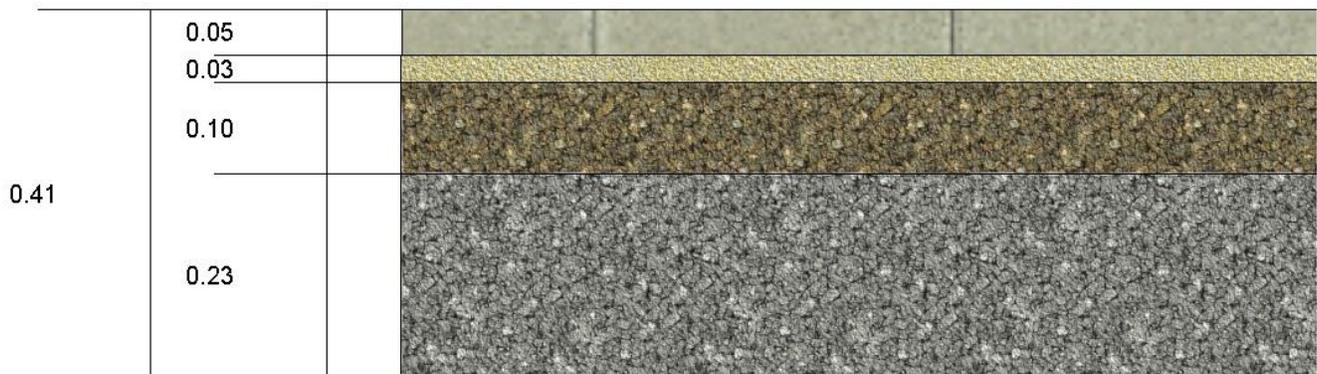
Fuente: Diseño de la estructura del pavimento articulado elaborado en Revit. Elaboración propia
