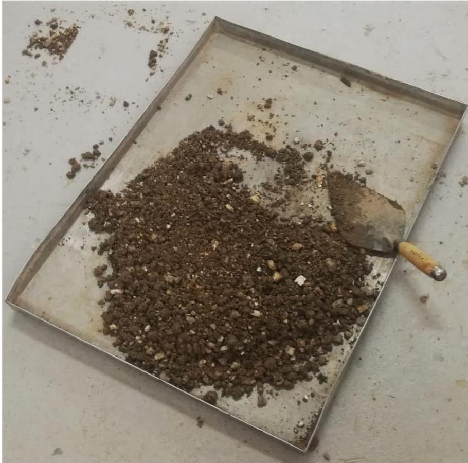
Fuente: Preparación de la muestra para llevar a cabo el ensayo de CBR. Elaboración propia
