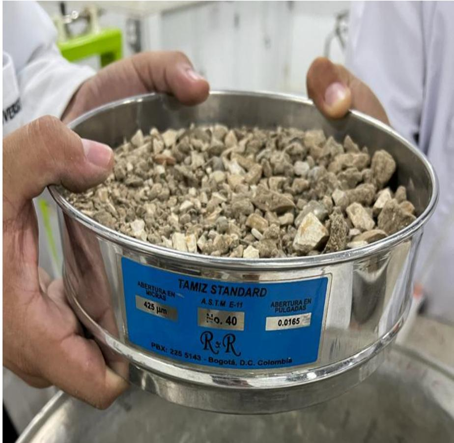
Fuente: Preparación y tamizado del material para el ensayo de Proctor para determinar la humedad óptima. Elaboración propia
