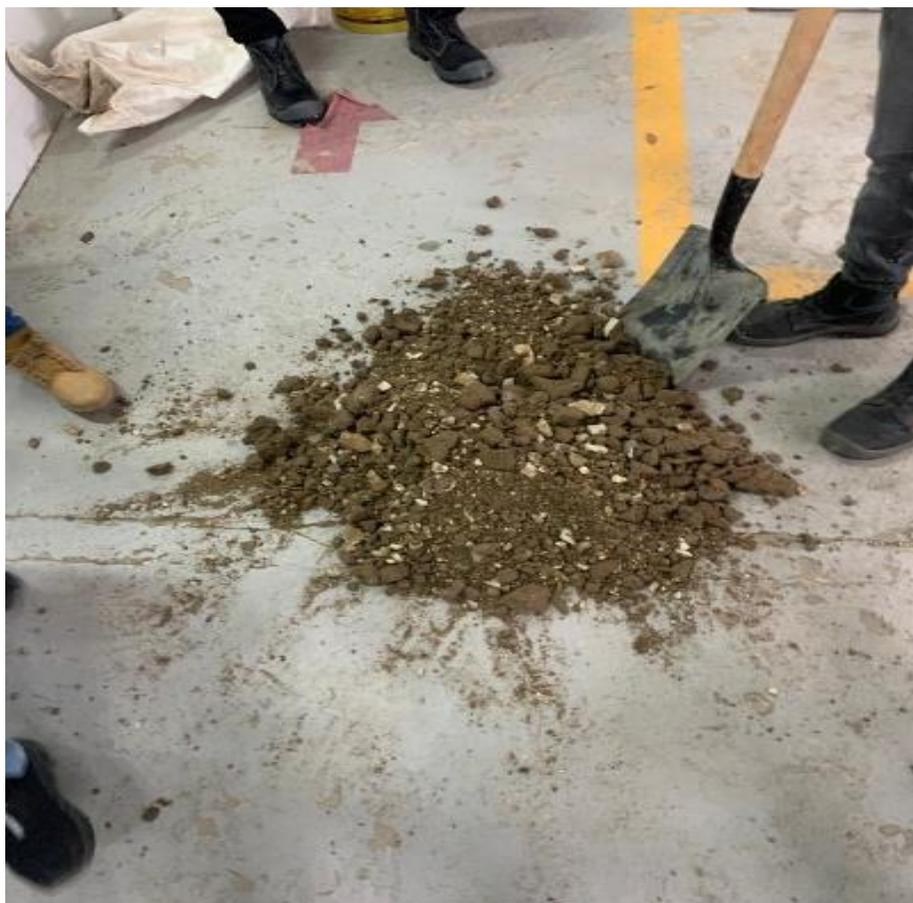
Fuente: Preparación de la muestra para el laboratorio de granulometría. Elaboración propia
