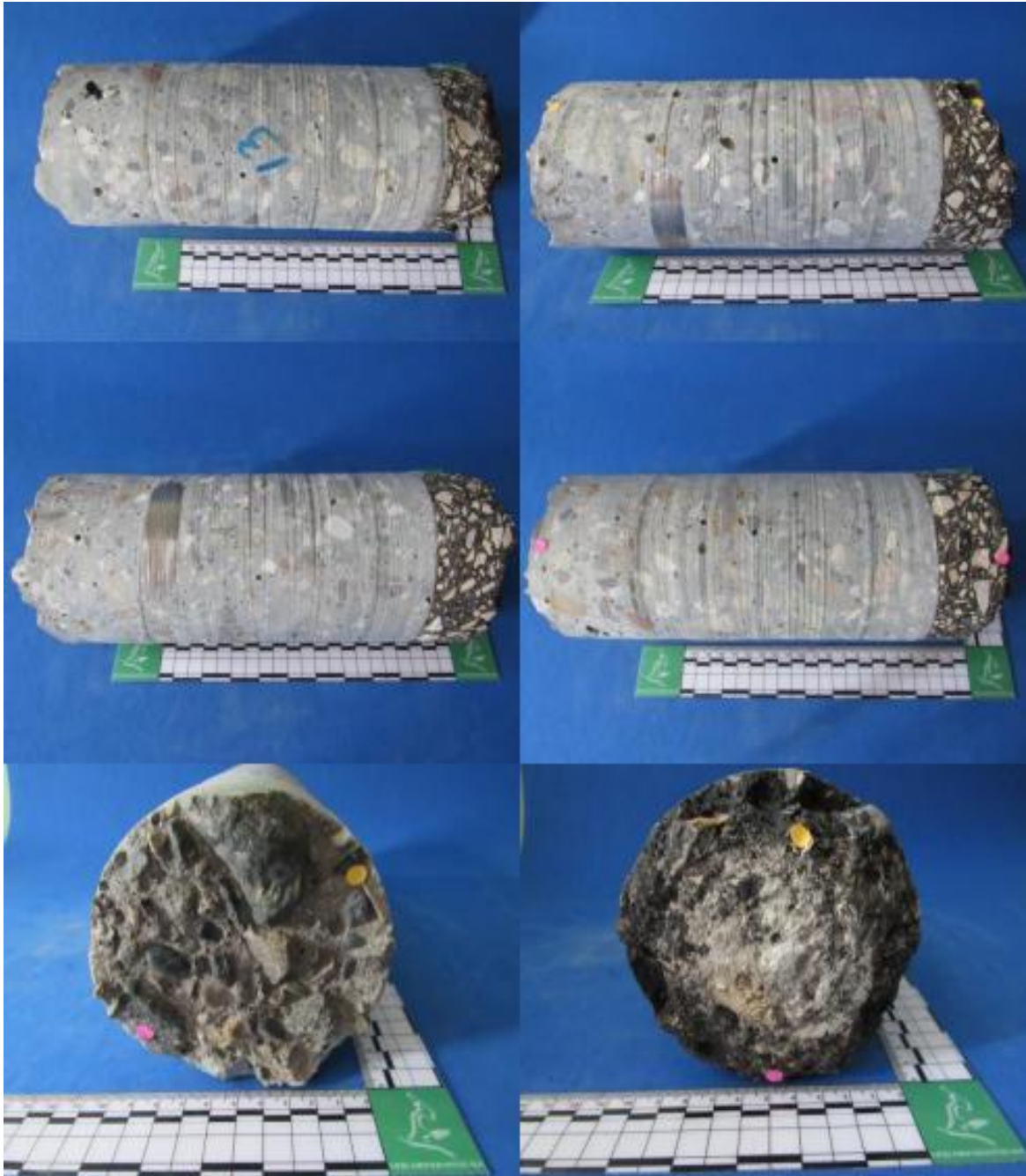
Figura 8. Muestra de núcleo de concreto 13, vistas laterales, superior e inferior. Los puntos amarillo y rosado muestran la orientación de los cortes, (2021).
