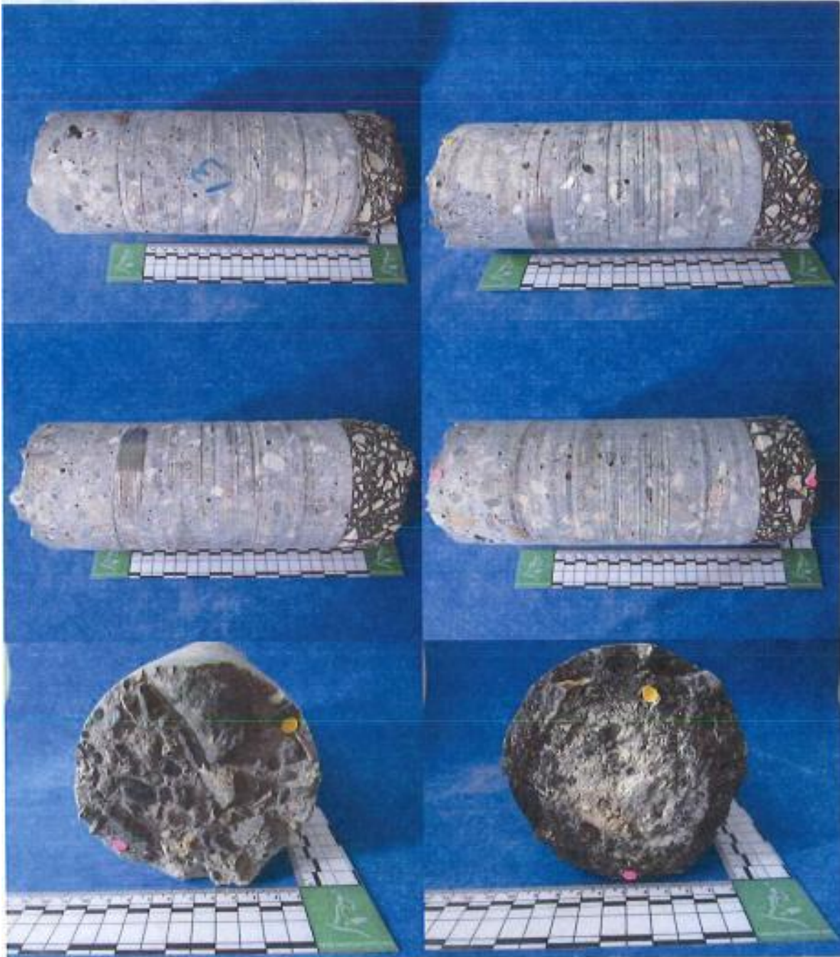
Figura 7. Muestra de núcleo de concreto 12, vistas laterales, superior e inferior. Los puntos amarillo y rosado muestran la orientación de los cortes, (2017).
