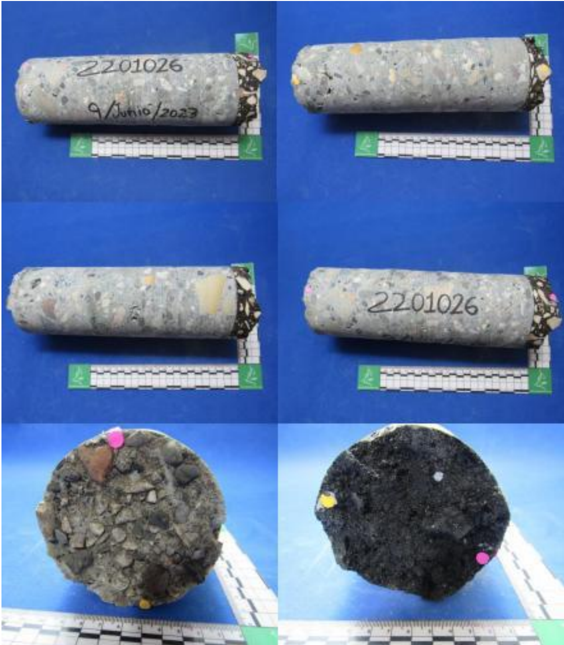
Figura 9. Muestra de núcleo de concreto 14, vistas laterales, superior e inferior. Los puntos amarillo y rosado muestran la orientación de los cortes, (2023).
