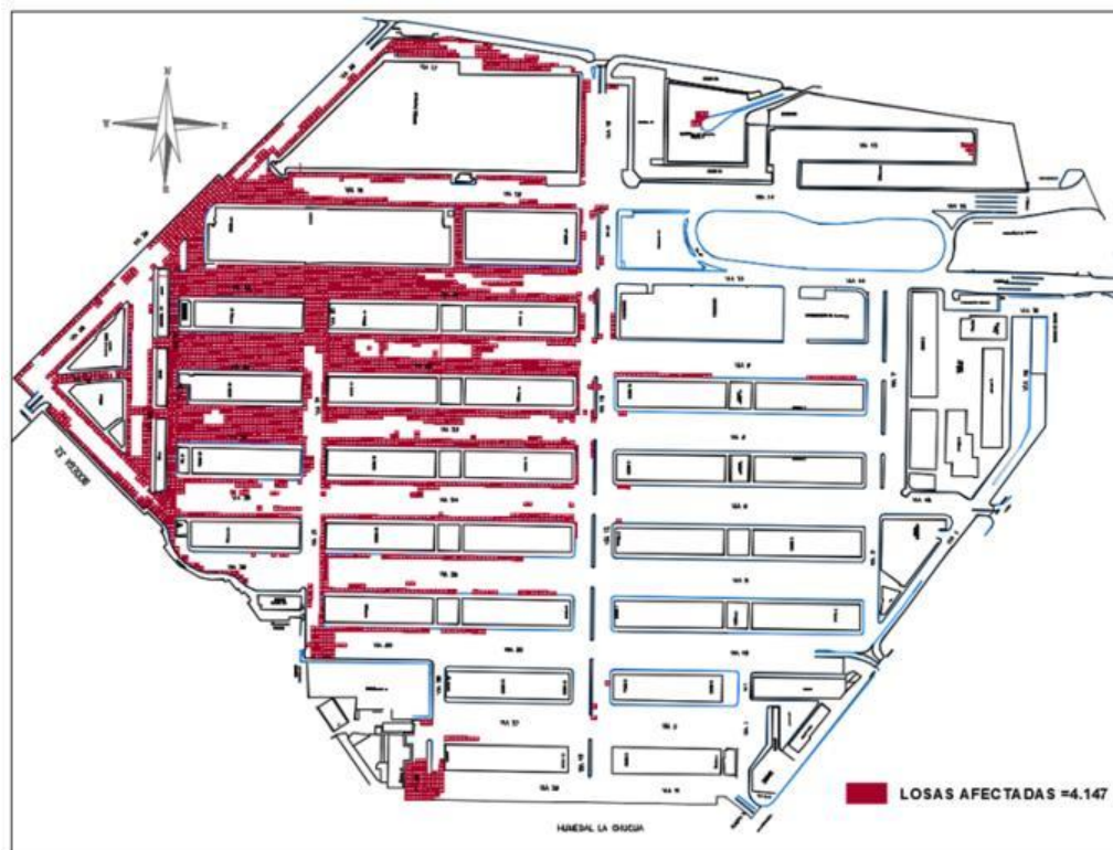
Figura 1. Losas afectadas en la central de Corabastos. Fuente: construcción propia.
