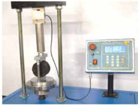
Figura 4. Fotografía ensayo de resistencia a la tracción indirecta Fuente: Elaboración de Eliana Martínez.
