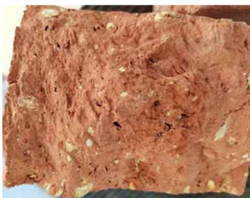
Figura 8. Fotografía de poros formados por la calcinación del aserrín
