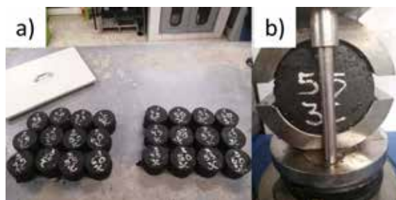
Figura 3. Fotografías ensayo Marshall: (a) Briquetas tipo MDC-19 y MDC-RCA; (b) Determinación de la Estabilidad y Flujo Marshall
