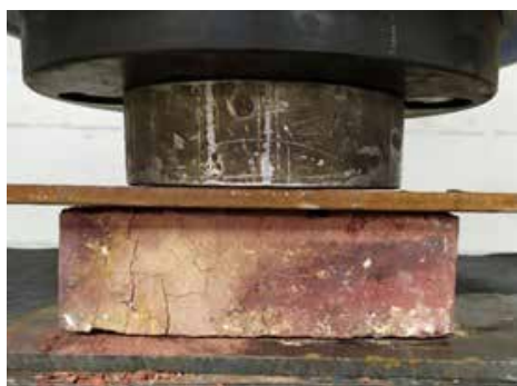
Figura 5. Fotografía de ensayo a compresión de ladrillos de mampostería Fuente: J. A. Becerra, 2019.
