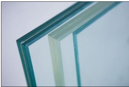
Figura 14. Vidrios de seguridad.
