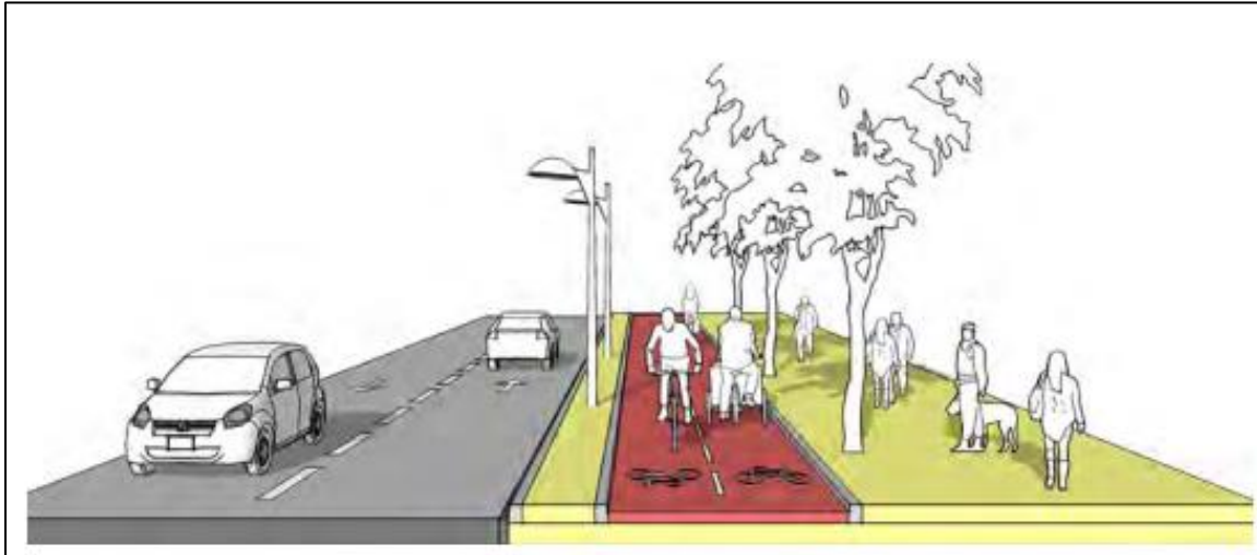
Figura 4. Perfil de ciclorruta en calzada bidireccional.
