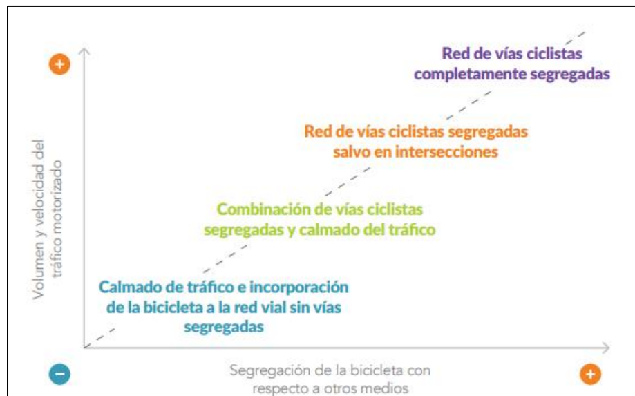
Figura 2. Identificación y relación entre el tráfico motorizado y la segregación de la ciclo-infraestructura de las ciudades colombianas.
