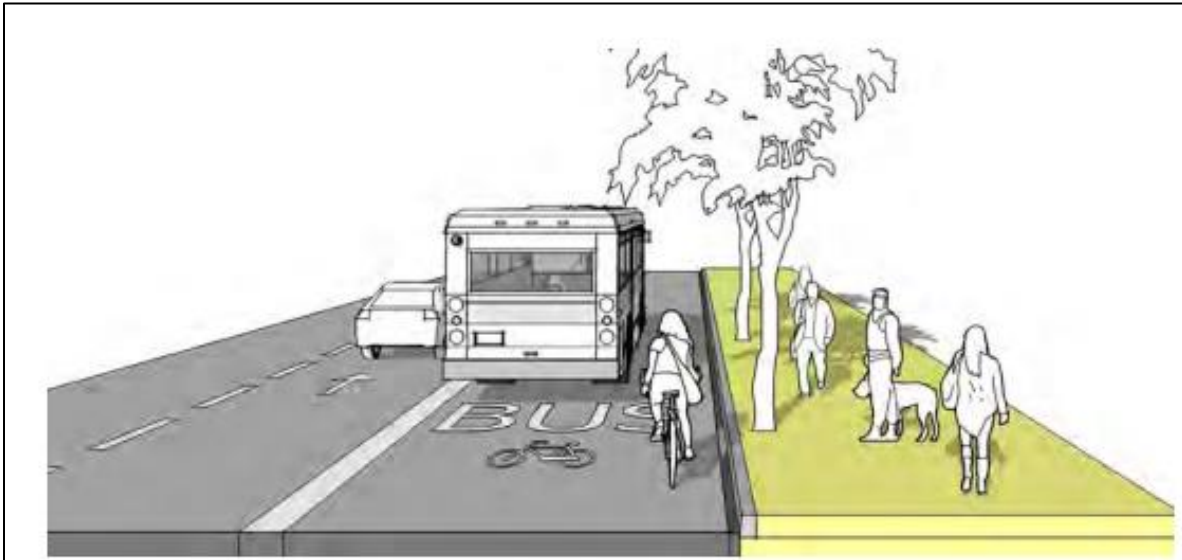
Figura 9. Perfil de carril bus – bici transito calmado he invasión de ciclistas en la calzada vehicular.
