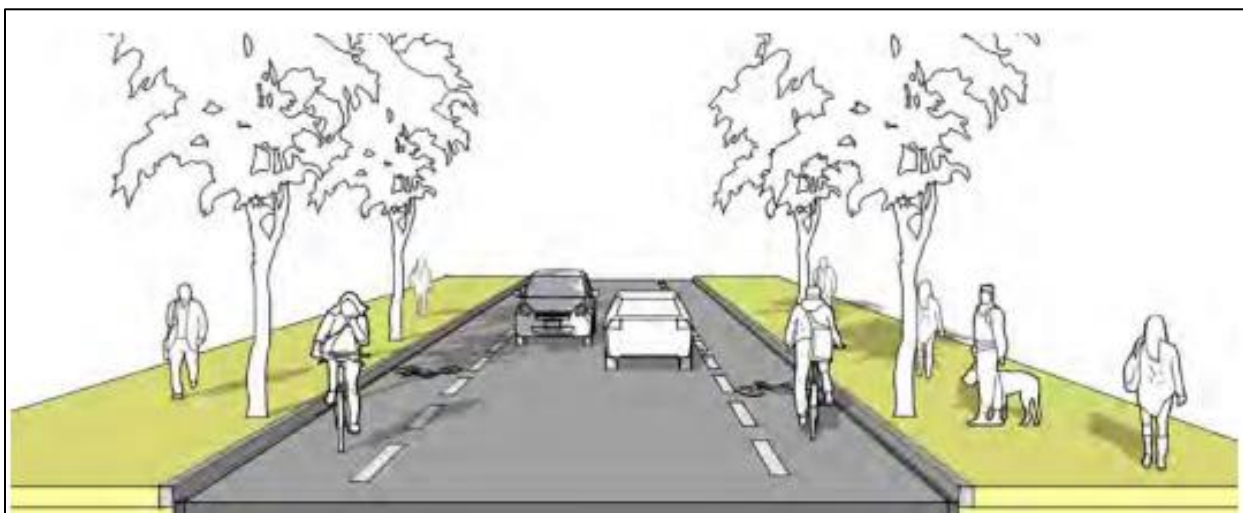
Figura 7. Perfil de banda ciclo preferente para diseño de ciclovía.
