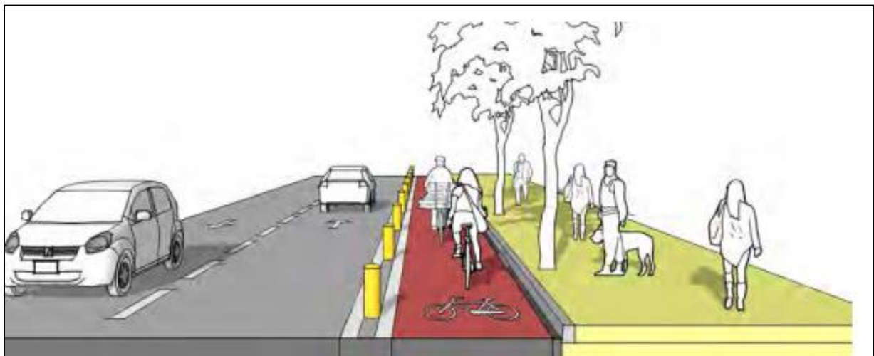
Figura 3. Perfil de ciclorruta en calzada unidireccional con bordillos.
