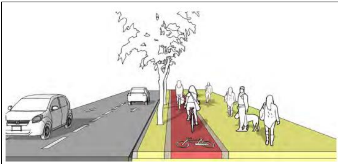
Figura 6. Perfil de ciclo bandas unidireccional sobre andén.
