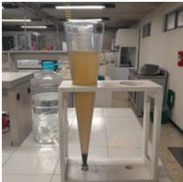
Figura 11: Ensayo cono de Imhoff. Fuente: Autoría propia
