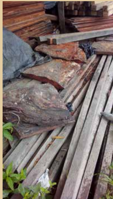
Piezas madera utilizadas para cimentación
