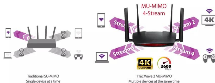
Figura 7. Diferencia entre la tecnología SU-MIMO Y MU-MIMO.
