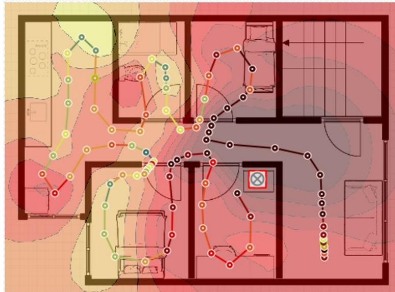
Figura 43. Mapa de calor red 2.4GHz antes de implementar las recomendaciones
