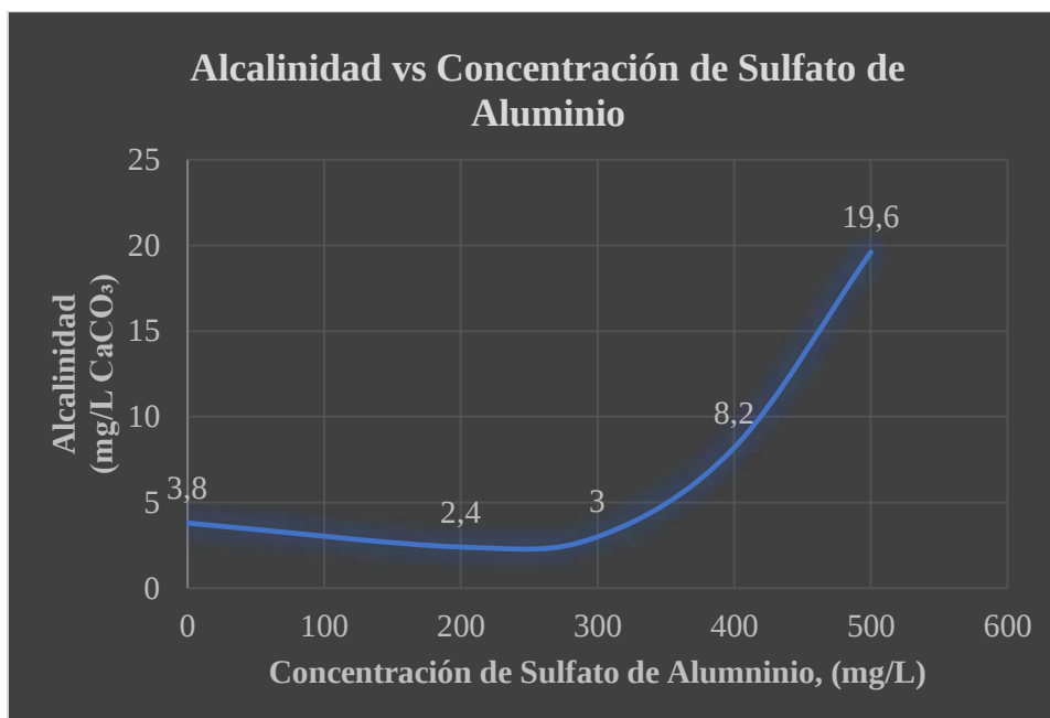
Gráfico 38. Alcalinidad vs Concentración de Sulfato de Aluminio
