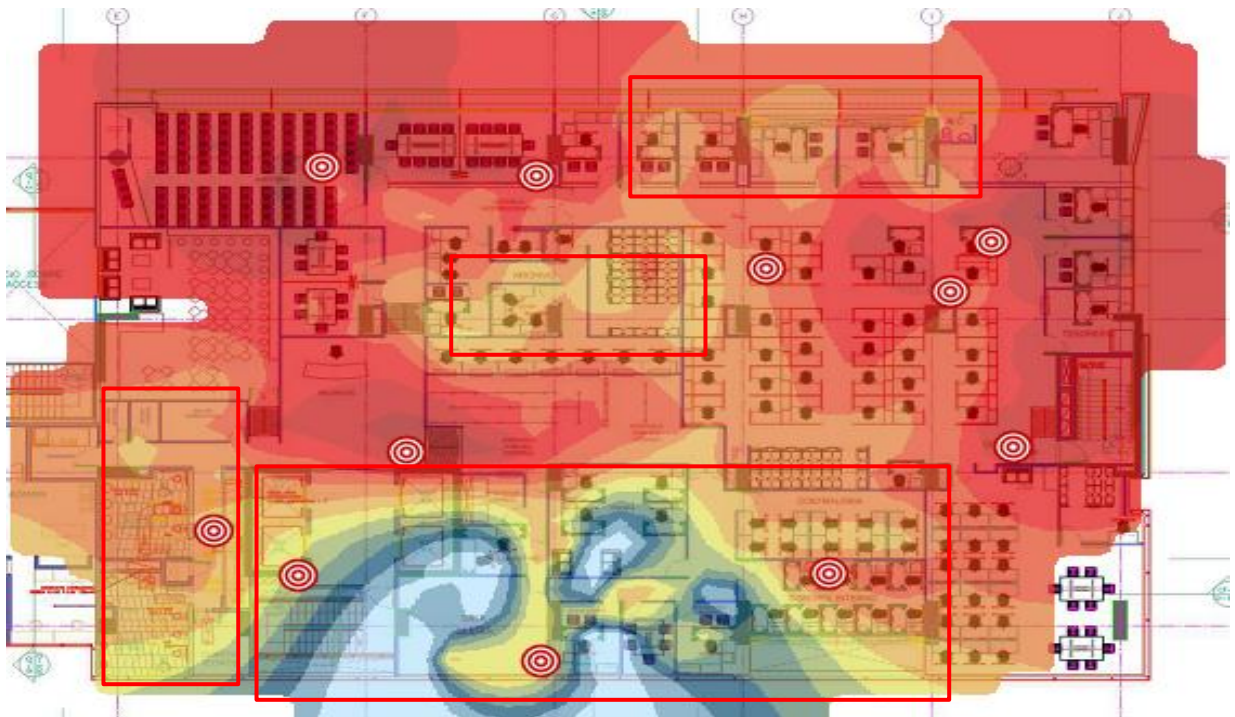
Figura 6 Falencias de cobertura
