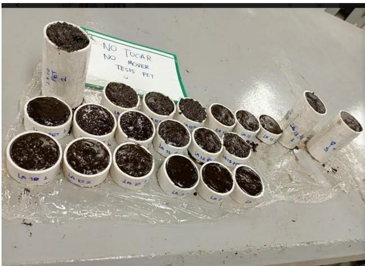
Probetas utilizadas para las pruebas de compresión y tracción
