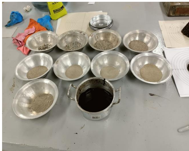
Aquí se observa la diferencia de volúmenes ocupados por los tipos de material empleados para la mezcla.
