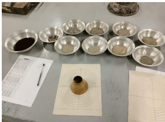
Dosificación agregados prueba de rotura.
