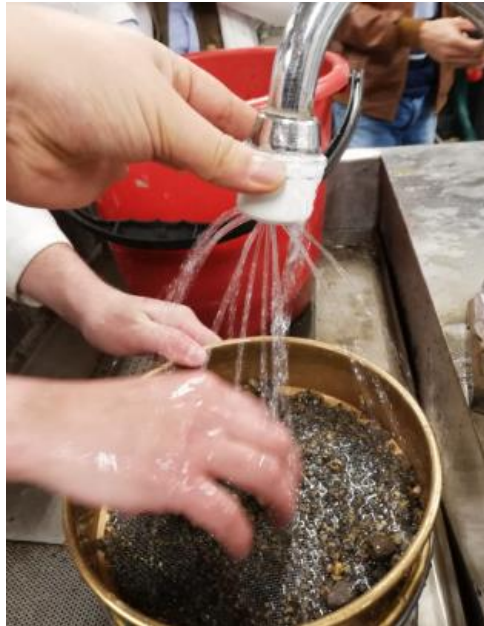
Figura 20. Lavado del material.
