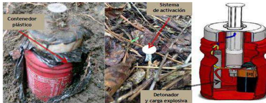
Figura 3. Diseño interno de algunas minas antipersona (centro nacional contra artefactos explosivos y minas, n.d.)
