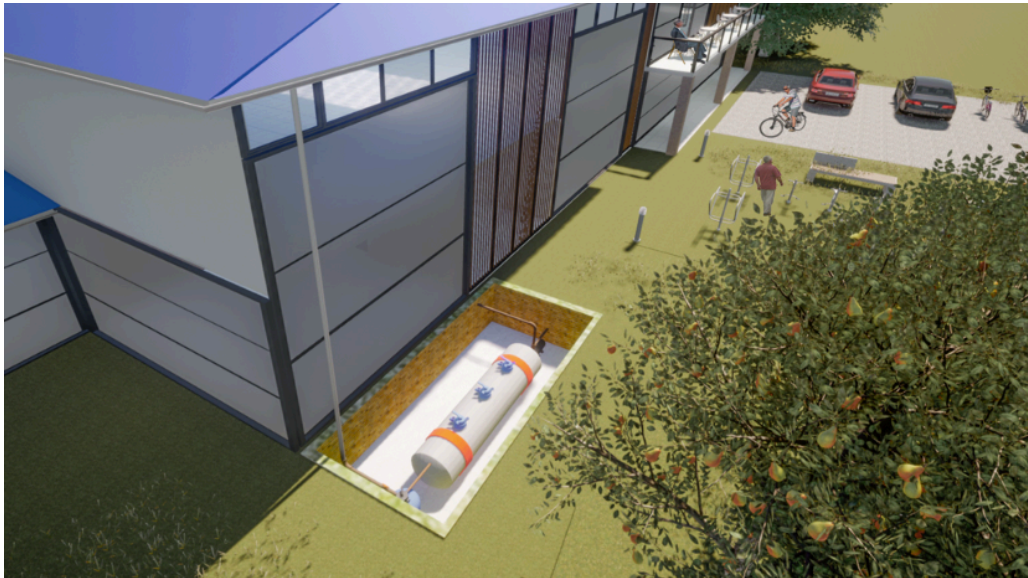
Imagen 9.1, sistema recolección de aguas lluvias.
