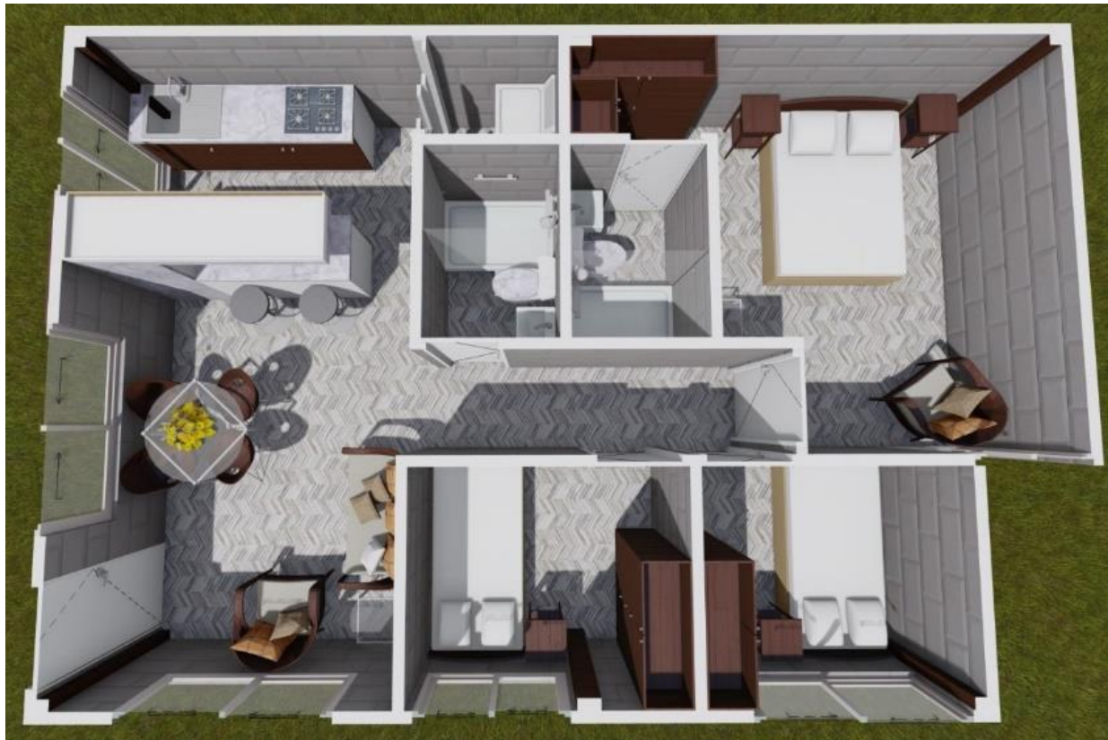
Ilustración 8. Distribución arquitectónica unidad de vivienda individual.
