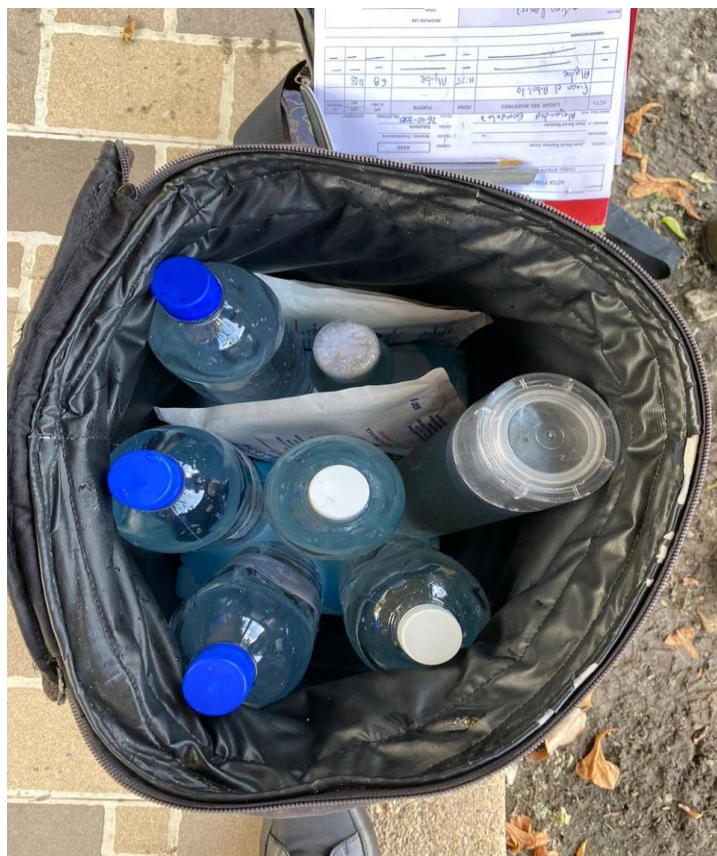
Ilustración 5 Muestras reposadas en embaces para llevar al laboratorio. Fuente: Autoría propia
