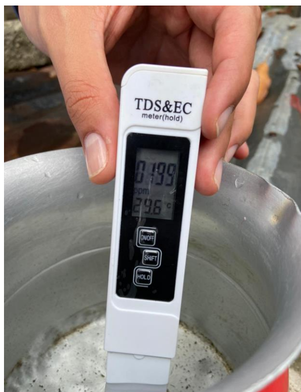
Ilustración 24 Toma de muestras fisicoquímicas IN-SITU Fuente: Autoría propia
