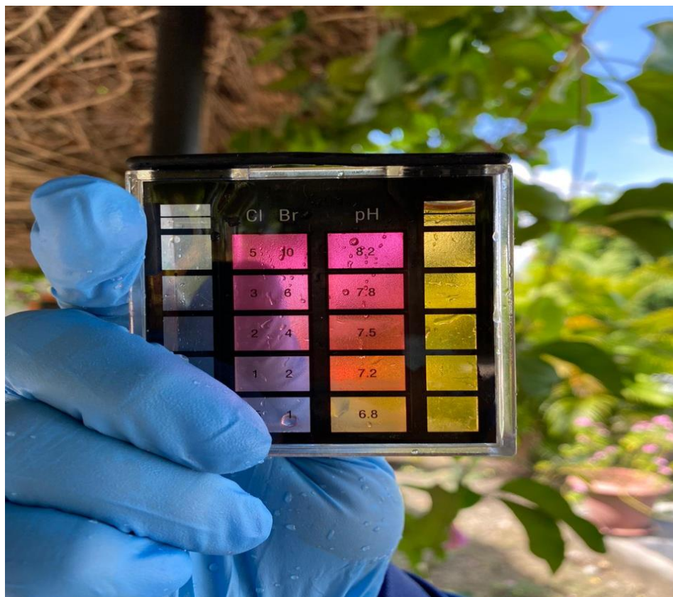
Ilustración 7 Resultados toma del PH, del agua subterránea del pozo caso de estudio. Fuente: Autoría propia.
