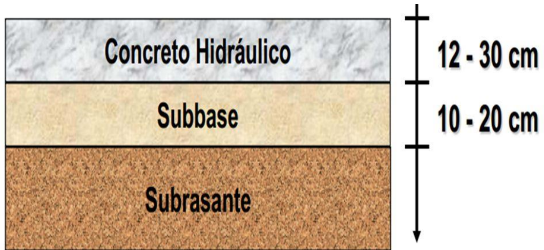
Figura 3. Estructura de un pavimento rígido.
