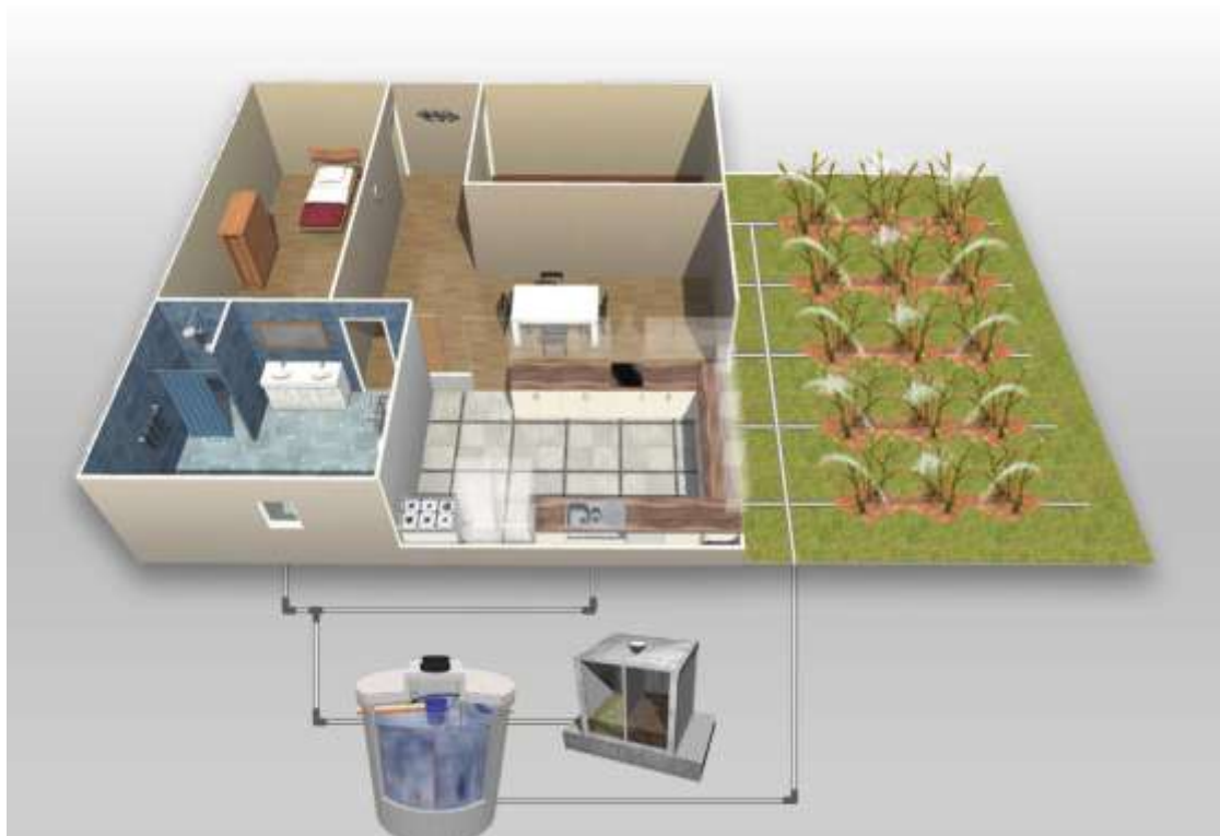
Ilustración 4. Esquema de Filtro Verde (Caña Brava)
