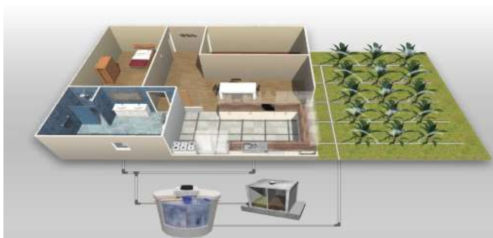
Ilustración 5 Diseño de Filtro Verde (Plantas de Banano)
