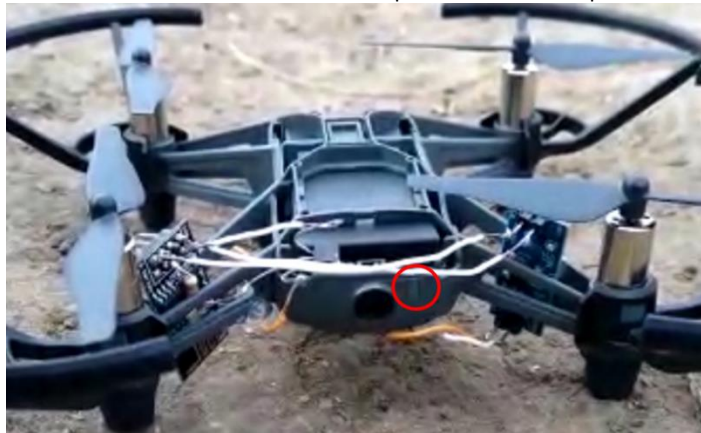
Figura 82. Dron encendido con sistema de encendido remoto implementado en campo
