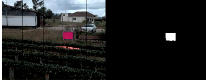
Figura 52. Detección de la estación de aterrizaje
