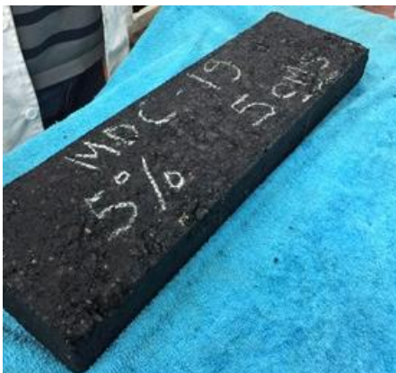
Figura 5. Ejemplo de probetas de mezclas asfálticas
