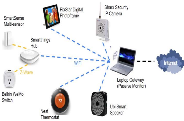
Figura 2. [4] Elementos básicos de automatización de hogares
